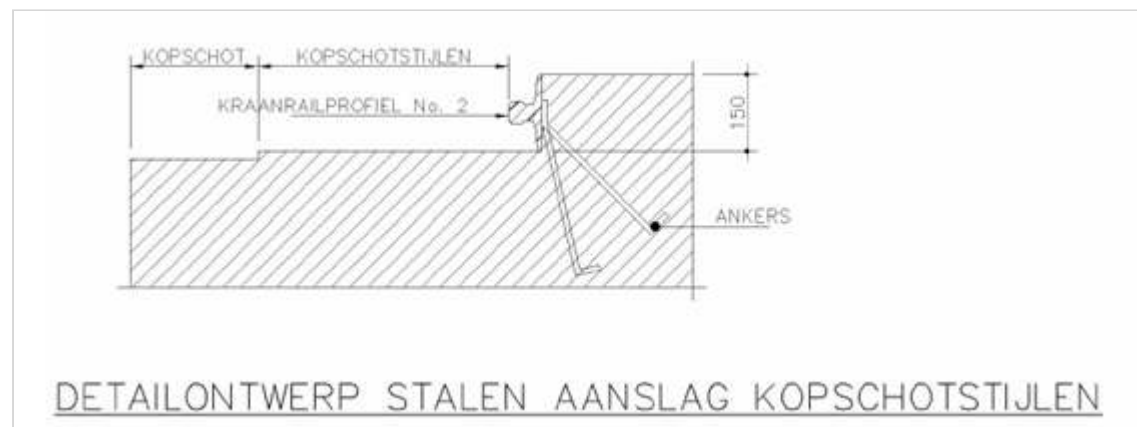
Figuur 365.1 - Detailontwerp stalen aanslag kopschotstijlen
