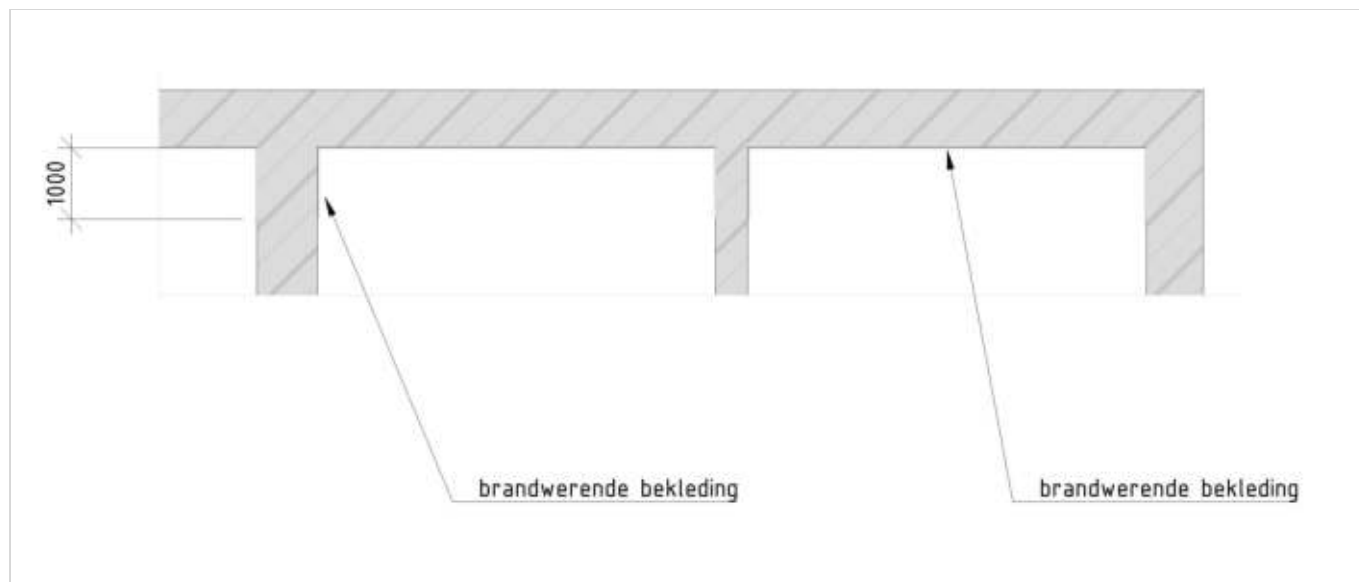
Figuur 498.4 - Principe doorsnede tunnel met brandwerende bekleding
