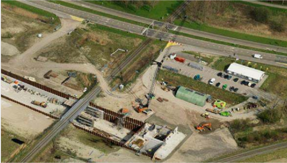
Figuur 523.1 - Voorbeeld inrichting bouwplaats
