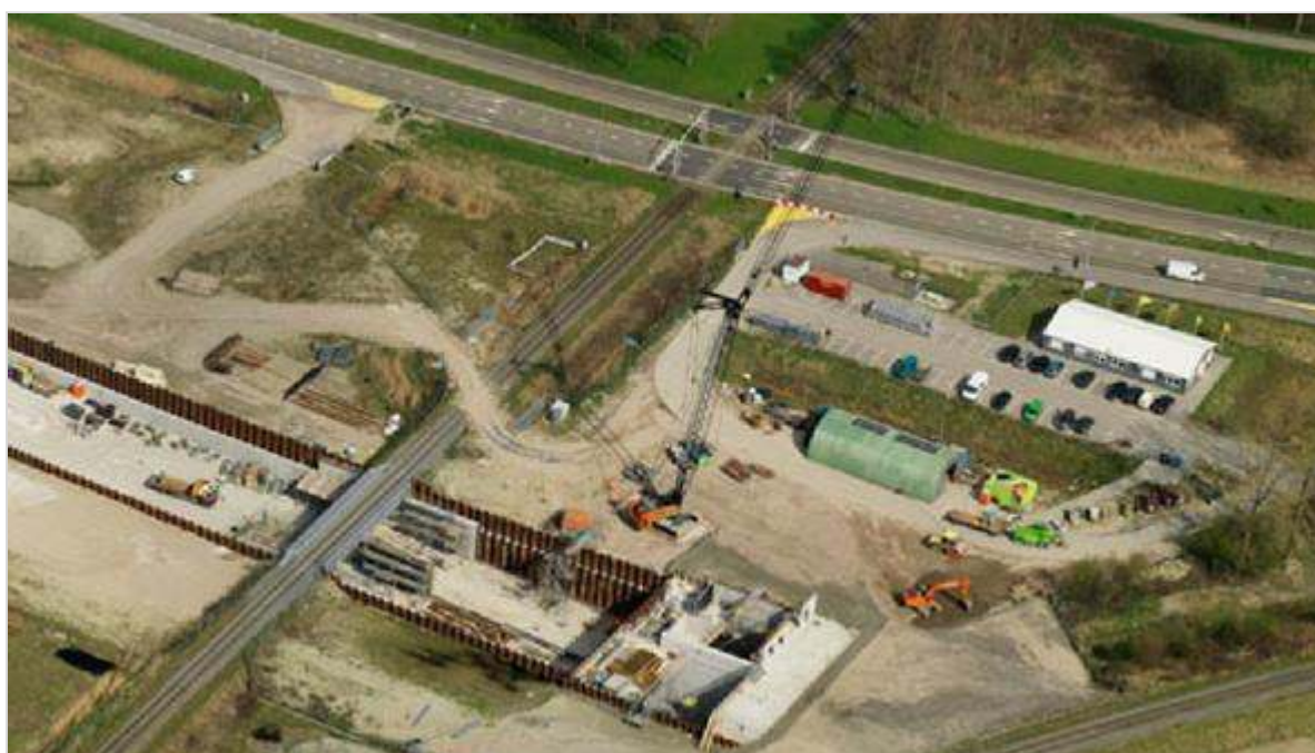
Figuur 523.1 - Voorbeeld inrichting bouwplaats
