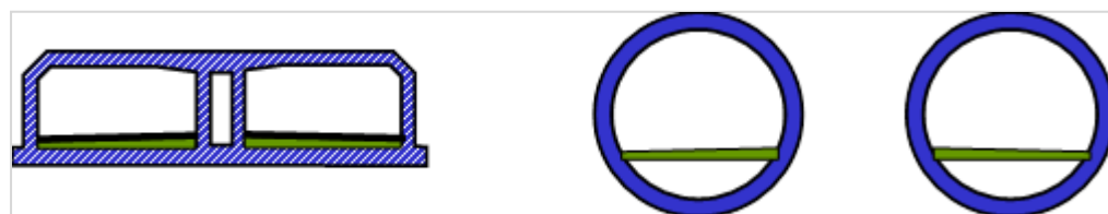
Figuur 7.4 - Rechthoekige en ronde tunneldoorsnede
