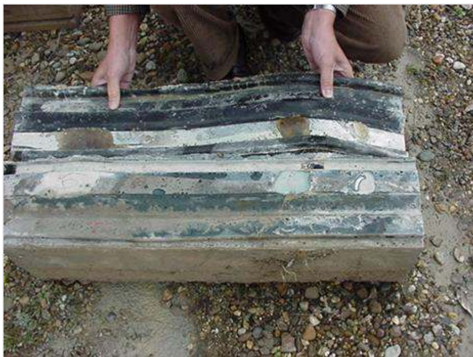
Figuur 248.1 - W9U profiel met luchtinsluitingen doordat de zijden niet waren opgebogen
