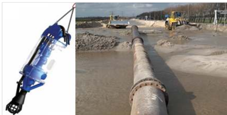
Figuur 597.1 DOP-pomp (links) en transportleiding (rechts)
