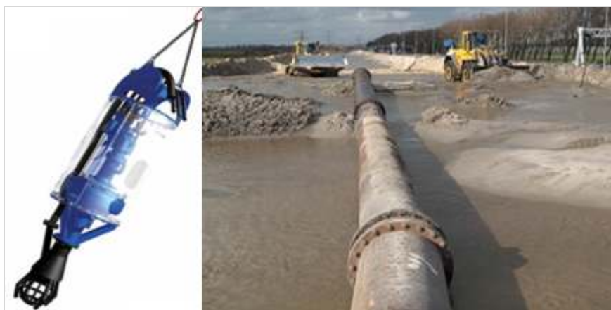
Figuur 597.1 DOP-pomp (links) en transportleiding (rechts)
