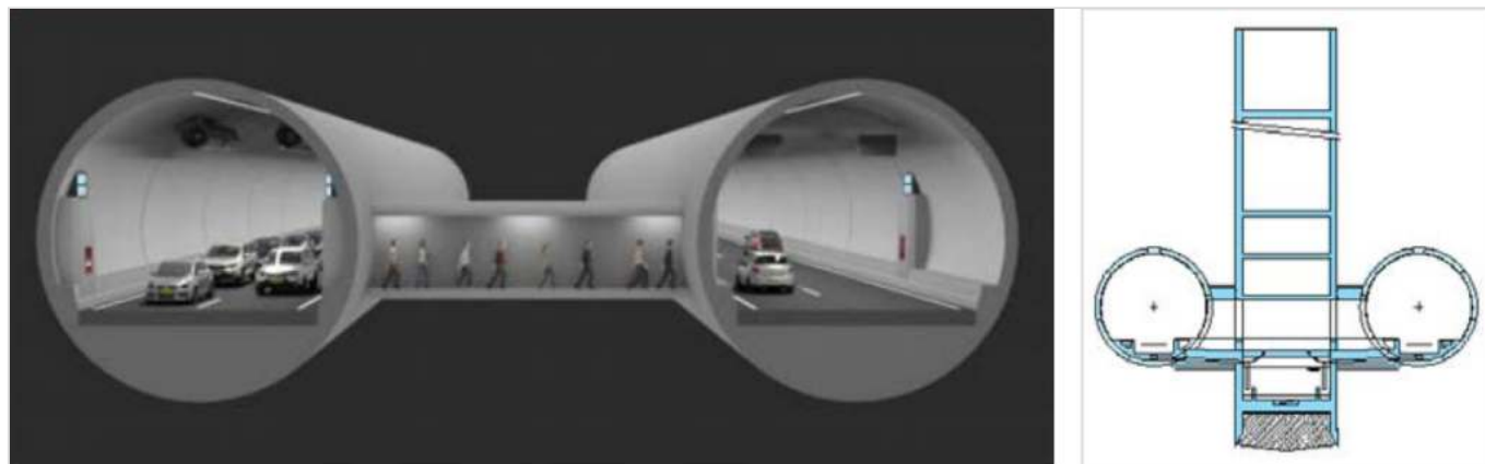
Figuur 690.10 - Principe van dwarsverbinding. (Beelden: RijnlandRoute/Cement)
