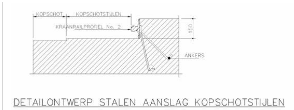
Figuur 365.1 - Detailontwerp stalen aanslag kopschotstijlen
